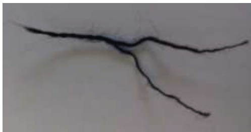
Fig. 17 Fir de bumbac din urzeală răsucit în S din două fire torsionate în Z
