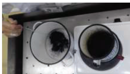
Fig. 39 Scoaterea materialului vopsit în baia de fixare (apă caldă cu 1% acid acetic glacial)
