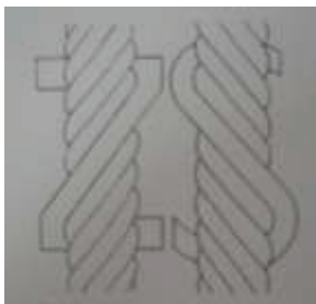
Fig. 16 Torsionarea firelor Z sau S
