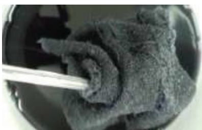
Fig.40 Vopsire după rețetă a țesăturii – astar de lână și menținerea fixării timp de 15 min.
