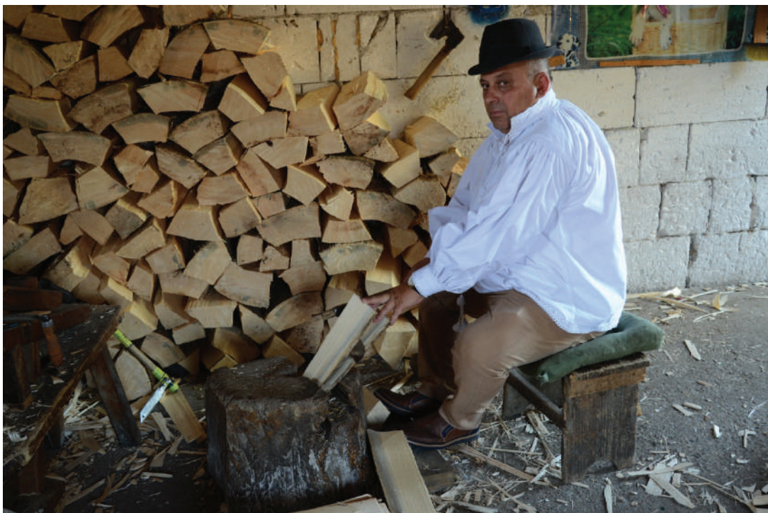
Meșterul popular Tiran Petru confecționând draniță (șindrila) Popular craftsman Petru Tiran manufacturing shingles (shakes)
