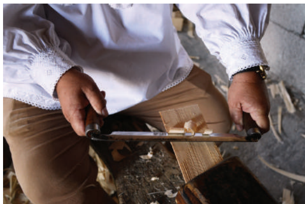
Meșterul popular Tiran Petru confecționând draniță (șindrila) Popular craftsman Petru Tiran manufacturing shingles (shakes)
